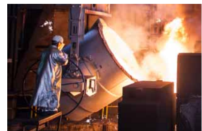
Zu sehen ist die Vorbereitung eines Abgusses. Ein Mitarbeiter entfernt Schlacke von der Schmelzoberfläche, bevor eine Form abgossen wird.
