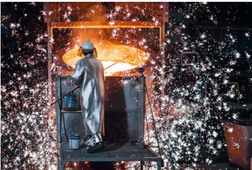
Zu sehen ist die Vorbereitung eines Abgusses. Ein Mitarbeiter entfernt Schlacke von der Schmelzoberfläche, bevor eine Form abgossen wird.
